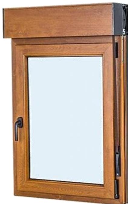
Perfil Aluplast 70 mm 5 Cámaras. Transmitancia Térmica Perfil 1,30 Wm2k . Transmitancia Térmica vidrio 1,1 Wm2k. Coeficiente Térmico Uw = 1,35 Kw2K . Ventana Oscilo Batiente. Herraje Maco Seguridad 5 puntos. Anti Falsa maniobra. Manilla Secustic. Lama de persiana de aluminio.
