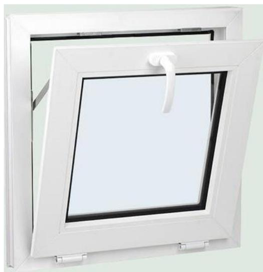
Perfil Aluplast 70 mm 5 Cámaras. Transmitancia Térmica Perfil 1,30 Wm2k . Transmitancia Térmica vidrio 1,0 Wm2k. Coeficiente Térmico Uw = 1,53 W/m2K . Ventana Basculante. Herraje Maco. Manilla Secustic.
