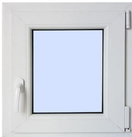
Perfil Aluplast 70 mm 5 Cámaras. Transmitancia Térmica Perfil 1,30 Wm2k . Transmitancia Térmica vidrio 1,0 Wm2k. Coeficiente Térmico Uw = 1,48 W/m2K . Ventana Oscilo Batiente. Herraje Maco Seguridad 5 puntos. Anti Falsa maniobra. Manilla Secustic
