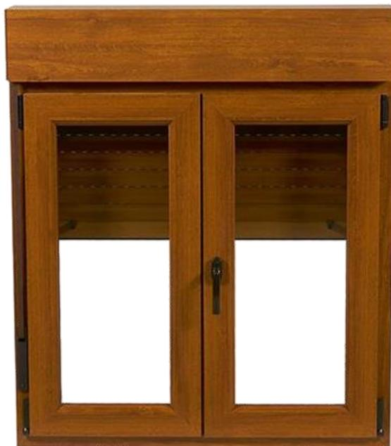
Perfil Aluplast 70 mm 5 Cámaras. Transmitancia Térmica Perfil 1,30 Wm2k . Transmitancia Térmica vidrio 1,0 Wm2k. Coeficiente Térmico Uw = 1,45 W/m2K . Ventana Oscilo Batiente. Herraje Maco Seguridad 5 puntos. Anti Falsa maniobra. Palanca de Rebajo en Hoja pasiva. Manilla Secustic. Lama de persiana de aluminio.
