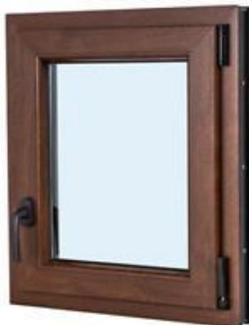
Perfil Aluplast 70 mm 5 Cámaras. Transmitancia Térmica Perfil 1,30 Wm2k. Transmitancia Térmica vidrio 1,0 Wm2k. Coeficiente Térmico Uw = 1,45 W/m2K . Ventana Oscilo Batiente. Herraje Maco Seguridad 5 puntos. Anti Falsa maniobra. Manilla Secustic.
