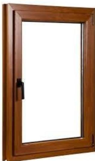
Perfil Aluplast 70 mm 5 Cámaras. Transmitancia Térmica Perfil 1,30 Wm2k . Transmitancia Térmica vidrio 1,0 Wm2k. Coeficiente Térmico Uw = 1,45 W/m2K . Ventana Oscilo Batiente. Herraje Maco Seguridad 5 puntos. Anti Falsa maniobra. Manilla Secustic.
