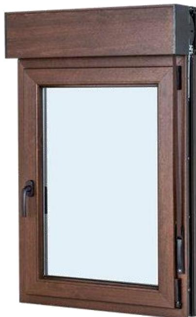
Perfil Aluplast 70 mm 5 Cámaras. Transmitancia Térmica Perfil 1,30 Wm2k . Transmitancia Térmica vidrio 1,0 Wm2k. Coeficiente Térmico Uw = 1,48 W/m2K . Ventana Oscilo Batiente. Herraje Maco Seguridad 5 puntos. Anti Falsa maniobra.. Manilla Secustik
