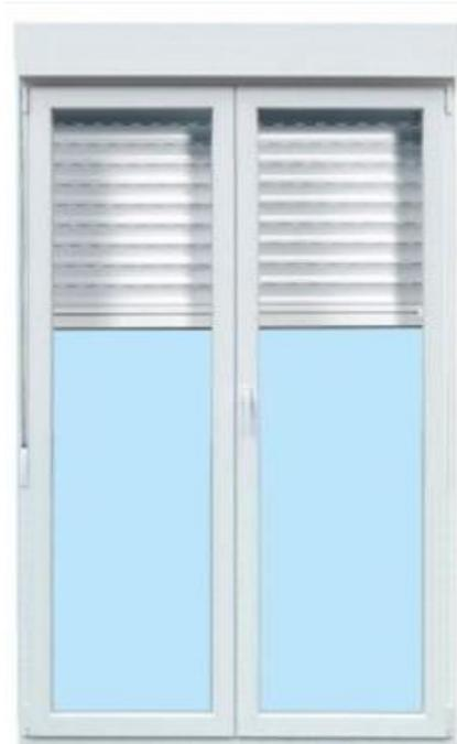
Perfil Aluplast 70 mm 5 Cámaras. Transmitancia Térmica Perfil 1,30 Wm2k . Transmitancia Térmica vidrio 1,1 Wm2k. Coeficiente Térmico Uw = 1,41 Kw2K . Ventana Oscilo Batiente. Herraje Maco Seguridad 5 puntos. Anti Falsa maniobra. Palanca de Rebajo en Hoja pasiva. Manilla Secustic. Lama de persiana de aluminio
