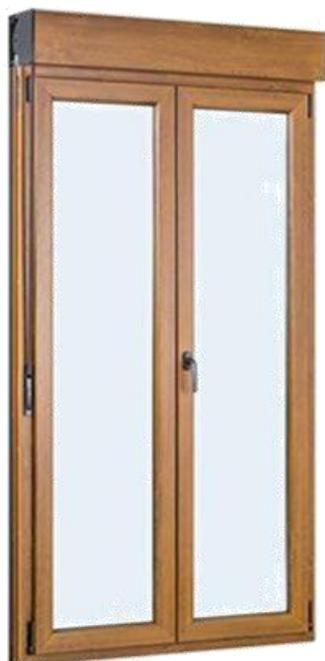
Perfil Aluplast 70 mm 5 Cámaras. Transmitancia Térmica Perfil 1,30 Wm2k . Transmitancia Térmica vidrio 1,1 Wm2k. Coeficiente Térmico Uw = 1,41 Kw2K . Ventana Oscilo Batiente. Herraje Maco Seguridad 5 puntos. Anti Falsa maniobra. Palanca de Rebajo en Hoja pasiva. Manilla Secustic. Lama de persiana de aluminio
