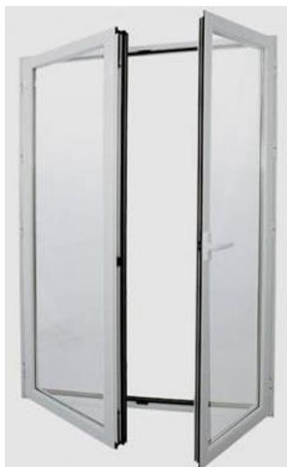
Perfil Aluplast 70 mm 5 Cámaras. Transmitancia Térmica Perfil 1,30 Wm2k . Transmitancia Térmica vidrio 1,1 Wm2k. Coeficiente Térmico Uw = 1,41 Kw2K . Ventana Oscilo Batiente. Herraje Maco Seguridad 5 puntos. Anti Falsa maniobra. Palanca de Rebajo en Hoja pasiva. Manilla Secustic
