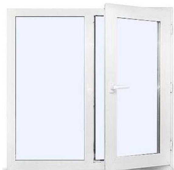
Perfil Aluplast 70mm 5 cámaras. Transmitancia Térmica Perfil 1,30 Wm2k Transmitancia Térmica vidrio 1,0 Wm2k. Coeficiente Térmico Uw= 1,51 W/m2K. Ventana Oscilo Batiente. Herraje Maco Seguridad 5 puntos. Anti Falsa maniobra. Palanca de Rebajo en Hoja pasiva. Manilla Secustic.
