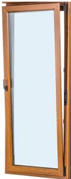
Perfil Aluplast 70 mm 5 Cámaras. Transmitancia Térmica Perfil 1,30 Wm2k . Transmitancia Térmica vidrio 1,0 Wm2k. Coeficiente Térmico Uw = 1,45 W/m2K . Ventana Oscilo Batiente. Herraje Maco Seguridad 5 puntos. Anti Falsa maniobra. Manilla Secustic.
