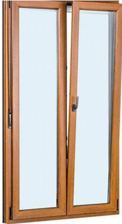
Perfil Aluplast 70 mm 5 Cámaras. Transmitancia Térmica Perfil 1,30 Wm2k. Transmitancia Térmica vidrio 1,0 Wm2k. Coeficiente Térmico  $U_w = 1,48 \text{ W/m}^2\text{K}$ . Ventana Oscilo Batiente. Herraje Maco Seguridad 5 puntos. Anti Falsa maniobra. Palanca de Rebajo en Hoja pasiva. Manilla Secustic.
