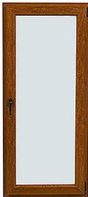
Perfil Aluplast 70 mm 5 Cámaras. Transmitancia Térmica Perfil 1,30 Wm2k . Transmitancia Térmica vidrio 1,1 Wm2k. Coeficiente Térmico Uw = 1,35 Kw2K . Ventana Oscilo Batiente. Herraje Maco Seguridad 5 puntos. Anti Falsa maniobra. Manilla Secustic.
