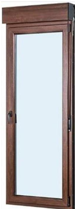
Perfil Aluplast 70 mm 5 Cámaras. Transmitancia Térmica Perfil 1,30 Wm2k . Transmitancia Térmica vidrio 1,1 Wm2k. Coeficiente Térmico Uw = 1,35 Kw2K . Ventana Oscilo Batiente. Herraje Maco Seguridad 5 puntos. Anti Falsa maniobra. Manilla Secustic. Lama de persiana de aluminio.
