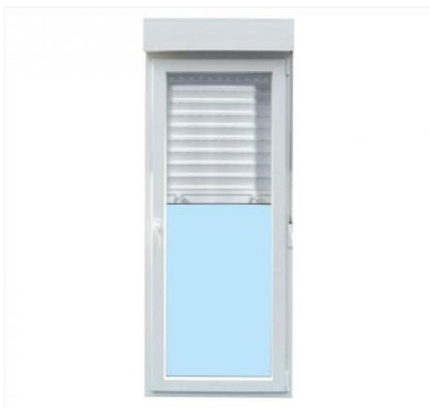
Perfil Aluplast 70 mm 5 Cámaras. Transmitancia Térmica Perfil 1,30 Wm2k . Transmitancia Térmica vidrio 1,1 Wm2k. Coeficiente Térmico Uw = 1,35 Kw2K . Ventana Oscilo Batiente. Herraje Maco Seguridad 5 puntos. Anti Falsa maniobra. Manilla Secustic. Lama de persiana de aluminio.
