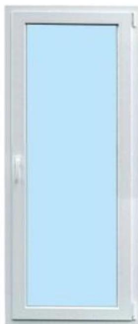
Perfil Aluplast 70 mm 5 Cámaras. Transmitancia Térmica Perfil 1,30 Wm2k . Transmitancia Térmica vidrio 1,1 Wm2k. Coeficiente Térmico Uw = 1,35 Kw2K . Ventana Oscilo Batiente. Herraje Maco Seguridad 5 puntos. Anti Falsa maniobra. Palanca de Rebajo en Hoja pasiva. Manilla Secustic.
