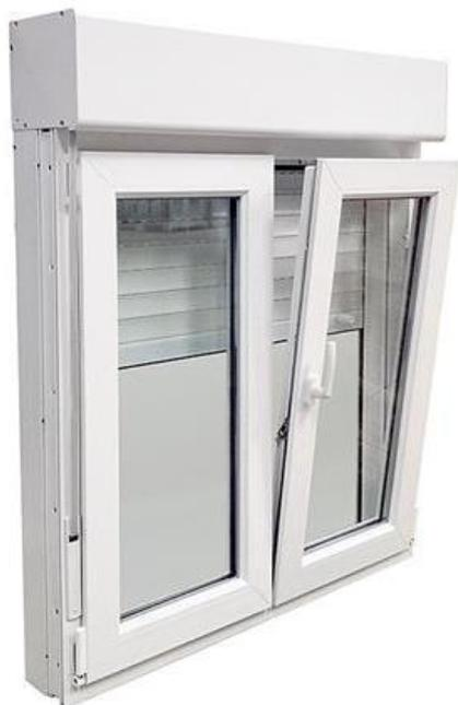
VENTANA PVC 1000X1155 BL C/PERS. 4/16AR/4 ONE DCHA Perfil Aluplast 70 mm 5 Cámaras. Transmitancia Térmica Perfil 1,30 Wm2k. Transmitancia Térmica vidrio 1,0 Wm2k. Coeficiente Térmico Uw = 1,51 W/m2K. Ventana Oscilo Batiente. Herraje Maco Seguridad 5 puntos. Anti Falsa maniobra. Palanca de Rebajo en Hoja pasiva. Manilla Secustic. Lama de persiana de aluminio
