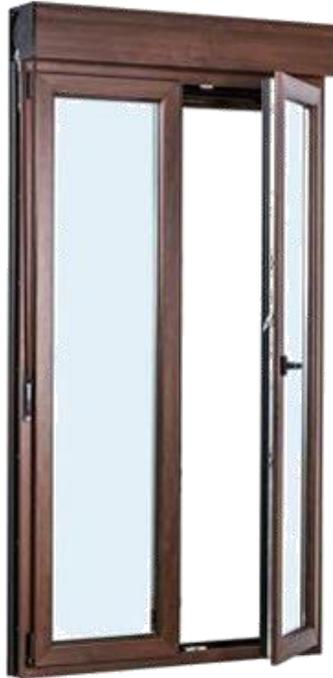
Perfil Aluplast 70 mm 5 Cámaras. Transmitancia Térmica Perfil 1,30 Wm2k . Transmitancia Térmica vidrio 1,0 Wm2k. Coeficiente Térmico Uw = 1,45 W/m2K . Ventana Oscilo Batiente. Herraje Maco Seguridad 5 puntos. Anti Falsa maniobra. Palanca de Rebajo en Hoja pasiva. Manilla Secustic. Lama de persiana de aluminio
