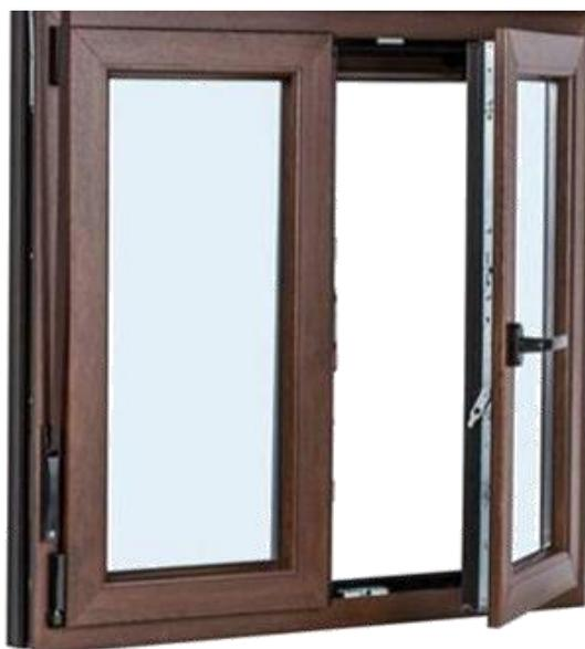
Perfil Aluplast 70 mm 5 Cámaras. Transmitancia Térmica Perfil 1,30 Wm2k. Transmitancia Térmica vidrio 1,0 Wm2k. Coeficiente Térmico Uw = 1,51 W/m2K . Ventana Oscilo Batiente. Herraje Maco Seguridad 5 puntos. Anti Falsa maniobra. Palanca de Rebajo en Hoja pasiva. Manilla Secustic.
