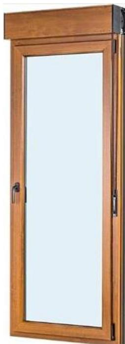
Perfil Aluplast 70 mm 5 Cámaras. Transmitancia Térmica Perfil 1,30 Wm2k. Transmitancia Térmica vidrio 1,0 Wm2k. Coeficiente Térmico  $U_w = 1,48 \text{ W/m}^2\text{K}$ . Ventana Oscilo Batiente. Herraje Maco Seguridad 5 puntos. Anti Falsa maniobra. Palanca de Rebajo en Hoja pasiva. Manilla Secustic.
