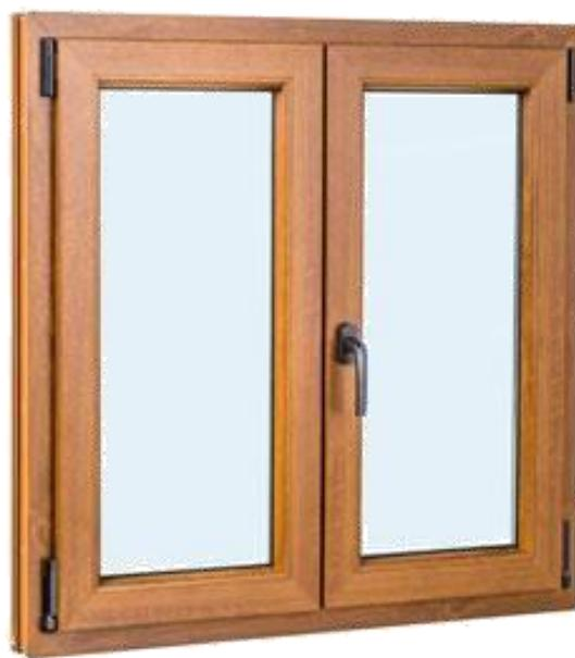
Perfil Aluplast 70 mm 5 Cámaras. Transmitancia Térmica Perfil 1,30 Wm2k. Transmitancia Térmica vidrio 1,0 Wm2k . Coeficiente Térmico Uw = 1,45 W/m2K . Ventana Oscilo Batiente. Herraje Maco Seguridad 5 puntos. Anti Falsa maniobra. Manilla Secustic.
