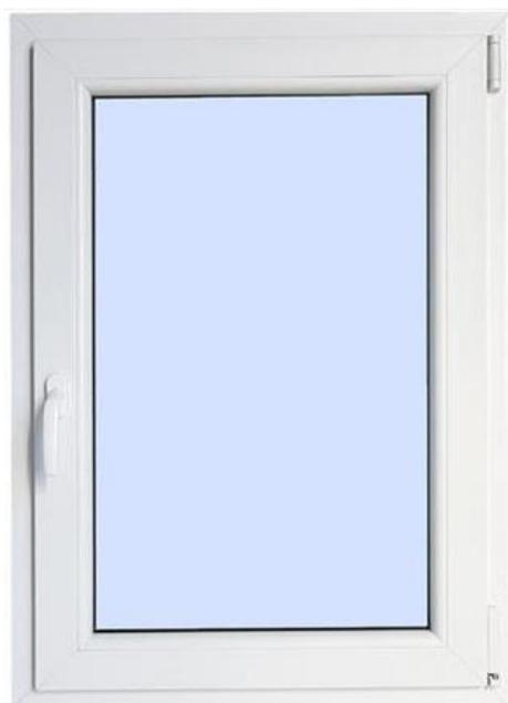
Perfil Aluplast 70 mm 5 Cámaras. Transmitancia Térmica Perfil 1,30 Wm2k . Transmitancia Térmica vidrio 1,0 Wm2k. Coeficiente Térmico Uw = 1,48 W/m2K . Ventana Oscilo Batiente. Herraje Maco Seguridad 5 puntos. Anti Falsa maniobra. Manilla Secustic
