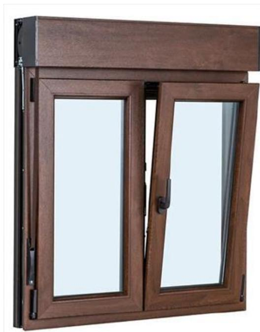
Perfil Aluplast 70 mm 5 Cámaras. Transmitancia Térmica Perfil 1,30 Wm2k . Transmitancia Térmica vidrio 1,0 Wm2k. Coeficiente Térmico Uw = 1,51 W/m2K . Ventana Oscilo Batiente. Herraje Maco Seguridad 5 puntos. Anti Falsa maniobra. Palanca de Rebajo en Hoja pasiva. Manilla Secustic. Lama de persiana de aluminio
